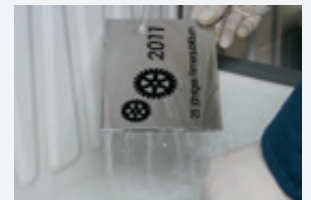
Direkt nach der Bearbeitung mit Wasser abspülen, um die Reaktion abzuschließen.
