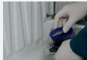
Aluoxyd mit einer mittelharten Bürste durch Reiben einwirken lassen.
